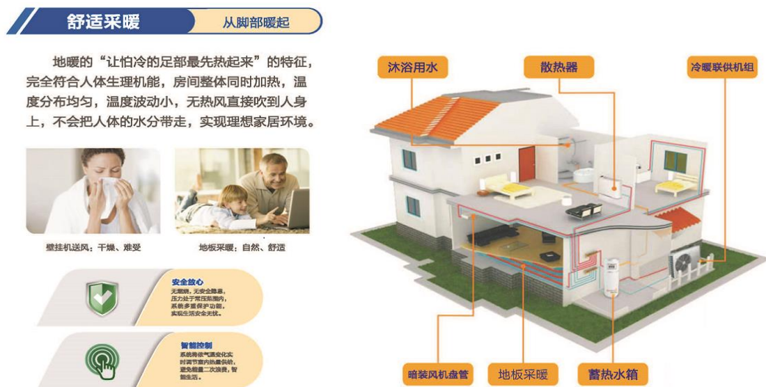
图 3：空气源热泵机组供暖方案
