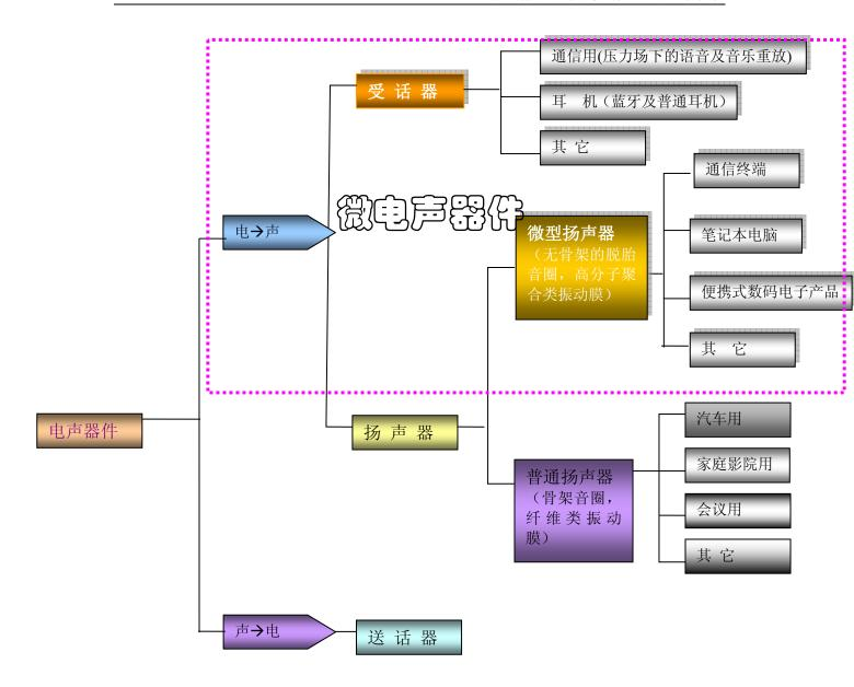
普通电声器件早在上世纪五十年代就实现了商品化。对于微电声器件,由于 人耳听觉需要一定的声音响度才能感受,需要较高的保真度才能悦耳,而电声器 件几何尺寸的缩小直接导致电声功率减小、频响曲线变坏。直到近十年,世界上 对于这个技术难题才有了突破性的进展。
