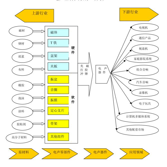
电声器件的上游产业是电声零部件,主要由振盆、音圈、振膜、磁体、T铁、盆架、定心支片、骨架以及垫边、夹板等,其中磁体(影响电声器件换能效率)、振盆(影响电声器件音质好坏)、音圈是主要的零部件。
