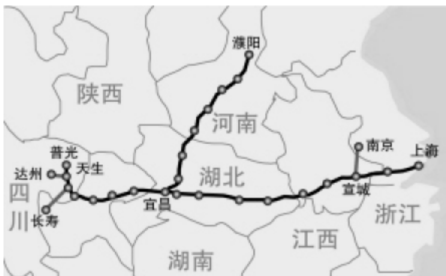
图 12：“川气东送”工程管道线路图
