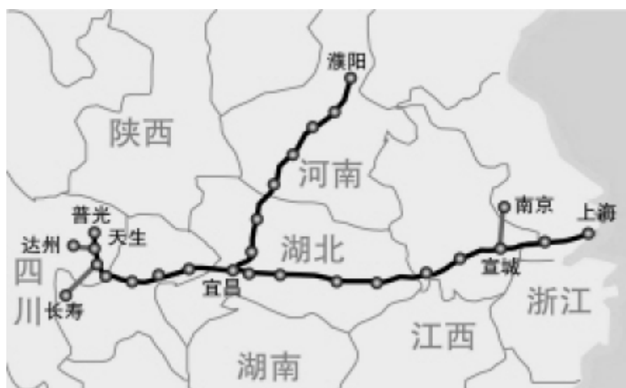
图 12：“川气东送”工程管道线路图
