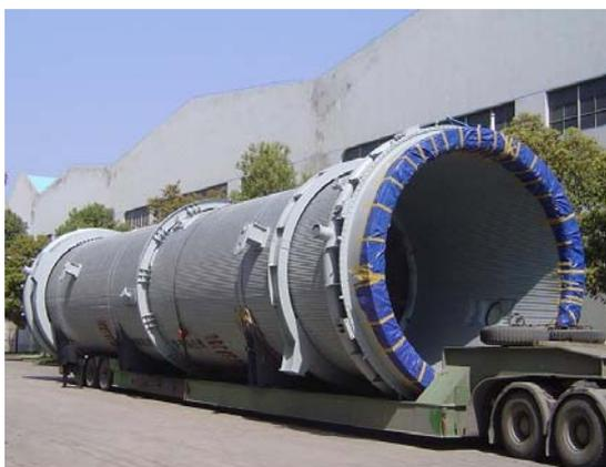
氧气转炉余热锅炉（直段）
