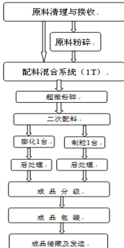
特种水产饲料生产工艺流程图
