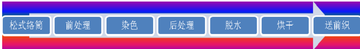
图6.13: 前织工艺流程图
