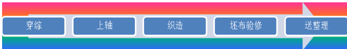
图6.14: 织造工艺流程图
