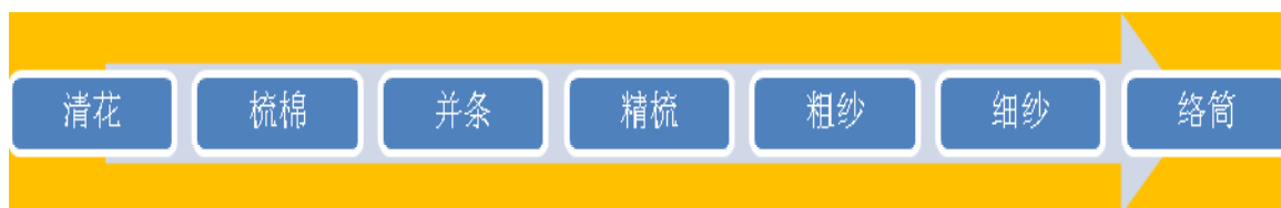
图6.17: 棉纱生产工艺流程图
