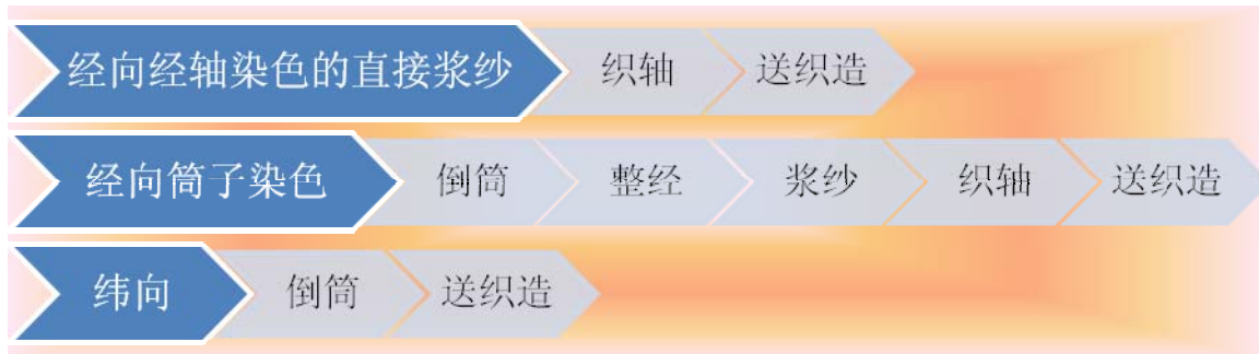
图6.13: 前织工艺流程图
