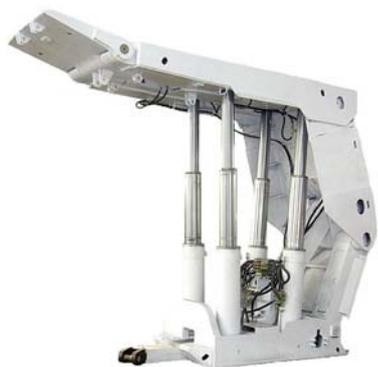
四柱支撑掩护式液压支架
