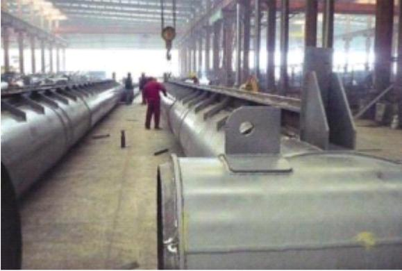
**埃及塞德港口设备项目**，为水泥灌浆设备，主要用于填充海域，扩建港口码头。该工程是由近 2,000 块异形结构件组成，形状有弓形、月牙形、椭圆形和圆管状等。公司为该项目提供钢结构件约 550 吨，金额 1,000 万元。（公司提供钢结构制作）
