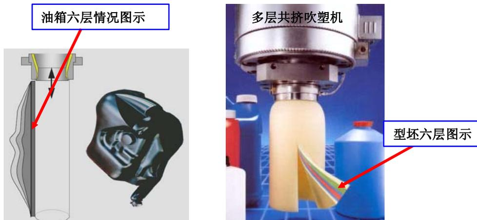
多层共挤塑料燃油箱从外到内依次分为六层:外表新料层、回料层、粘接层、阻隔层、粘接层、内壁新料层,具体结构和各层厚度的比例如下:
