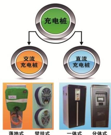
交流桩的技术特点主要是直接引入市电交流，对电动车进行慢充，重点考虑市电分配、防护、美观等。直流桩的技术较为复杂，输入电压采用三相四线 AC380V±15%，频率 50Hz,输出为可调直流电，直接为电动汽车的动力电池充电。由于直流充电桩采用三相四线制供电，可以提供足够的功率，输出的电压和电流调整范围大，可以实现快充的要求。
