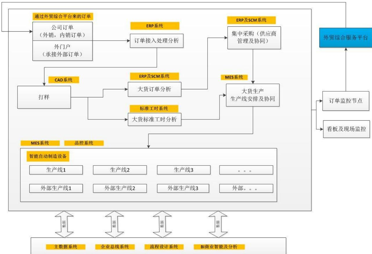
① 国外客户通过公司外贸综合服务平台，进入面料库和样衣库浏览和搜寻符合其要求的面料和服饰款式，或者国外客户直接提供设计方案；② 公司外贸平台接到设计方案后，根据系统中该客户的历史数据，结合客户对打样的时间要求，在系统中自动分配最优的生产线进行打样；③ 打样完成后，公司智能化生产系统（由 GSD、MES、ERP 和 SCM 等系统等构成）将根据生产线情况，结合客户对成本、品质、交期等要求，出具多套生产方案供公司客户选择；④ 客户确定生产方案签下订单后，集中采购平台将综合多个订单生产方案，统筹从合格供应商处采购各种面辅料并预估齐料时间，智能化生产系统将选择最优生产线合理排产；⑤ 国外客户可以通过外贸综合服务平台实时察看和监督生产线的生产情况和进度，工厂也可以根据客户要求，定期提供生产数据；在生产过程中，智能化生产系统可以在不改变交货期的情况下，根据客户对生产工艺、设计方案等调整情况重新统筹安排生产线生产；智能化生产系统可以对产品生产过程进行追溯，确保产品质量；⑥ 订单生产完成后，公司可以通过外贸综合服务平台实现一站式报关出口和结算，大幅提高外贸出口效率。
