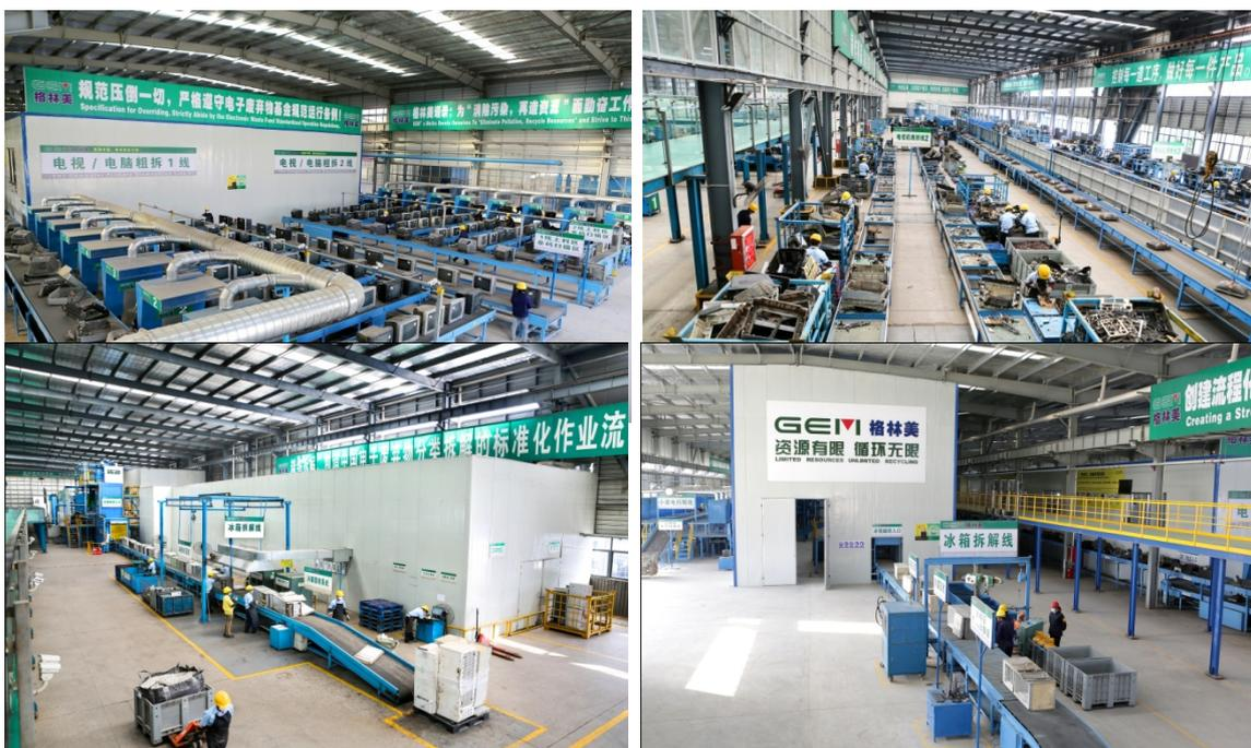
2015 年，公司代表世界领先水平的报废线路板处理线投入运行，该处理线采取无污染、零排放、零能源报废线路板处理技术，年处理 5 万吨，完全回收、产出金银铂钯铯镓锗铟等金属，标志公司电子废弃物处理产业链的完全拉通，成功解决电子废弃物报废线路板绿色处理的世界难题，是中国该领域唯一代表世界先进水平的第一条产线，
