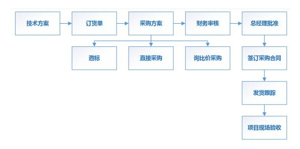
标的公司的采购方案分为邀标、直接采购和询比价采购三种,其中:邀标方式适用于主要设备的首次采购;直接采购方式适用于所需设备可靠来源少、工艺设计为保证达到工艺性能或质量要求而指定的特定供应商提供的设备、特殊条件下(如抢修、应急等)为了避免时间延误影响正常生产而紧急采购的设备、业主指定设备;询比价采购方式适用于标的公司以往已合作过的合格供应商、战略供应商或金额较小的标准设备及材料。
