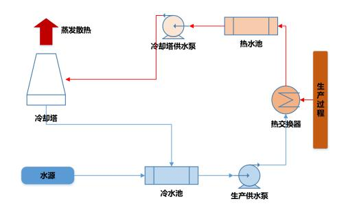
在循环冷却水系统中,循环水在热交换设备上带走生产过程所散发的热量, 升温后的循环水输往冷却塔,通过蒸发、风吹进行冷却,然后回到冷水池进行循 环利用。在整个过程当中,循环水的输送、补充需要离心泵、电机等设备持续进 行工作,耗电量很高;蒸发、风吹的散热过程中,耗水损失很大,使得系统需要持续从水源进行冷却水的补充,形成了水、电的消耗。因此,循环冷却水系统是工业中最大的耗水耗电项目之一,耗水量可达到企业总用水量的40%,用电负荷可达到企业总用电量的20-30%,是企业节能节水需要关注的重点领域之一。
