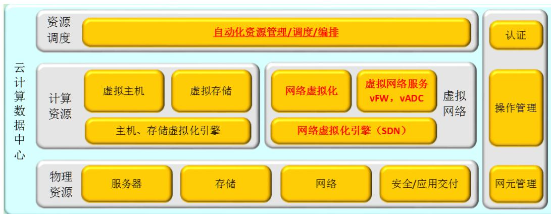
网润杰科按照 IaaS 的服务模式为用户构建云计算数据中心基础设施资源池，并为用户建立数据中心资源统一调度、管理、编排的管理平台，把数据中心基础设施以服务的形式交付给用户。用户自己将业务、应用和数据部署到数据中心基础上运行，并提供服务，而不需要关心数据中心的构建和运维。
