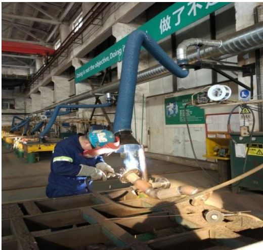
烟台来福士焊接车间的烟尘收集净化系统
