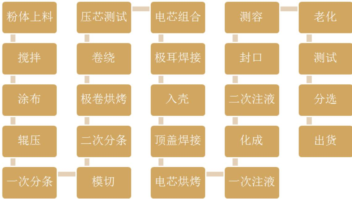
锂离子电池通常都由三大部分组成：由正负极片及隔膜卷绕或层叠而成的卷芯部分、用以提供浸润卷芯的电解液部分及外壳部分。其中正极极片是由三元材料、导电剂、和粘接剂涂覆在铝箔表面制备而成。负极由碳石墨负极、导电剂、和粘接剂涂覆在铜箔表面制备而成。正负极片中间夹一层隔膜通过卷绕或叠片的方式制成卷芯。
