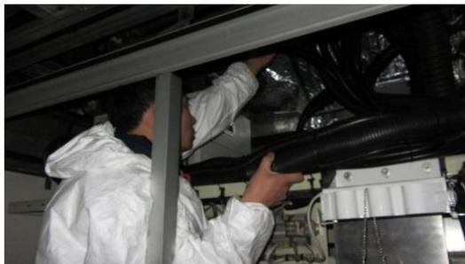
**CIR 改造服务：**CIR 系统是动车组车辆使用的通信系统的简称，是动车组重要的信息控制系统。目前，动车上现有的通信系统的功能已经无法满足日常业务需要，需要进行升级改造。龙铁纵横的具体业务是对动车组车辆内的数据线、电缆、通信部件进行拆卸、更换、软件升级和重新安装，以提高该系统的数据容量、通信速度、稳定性，满足当前动车组的运营要求。
