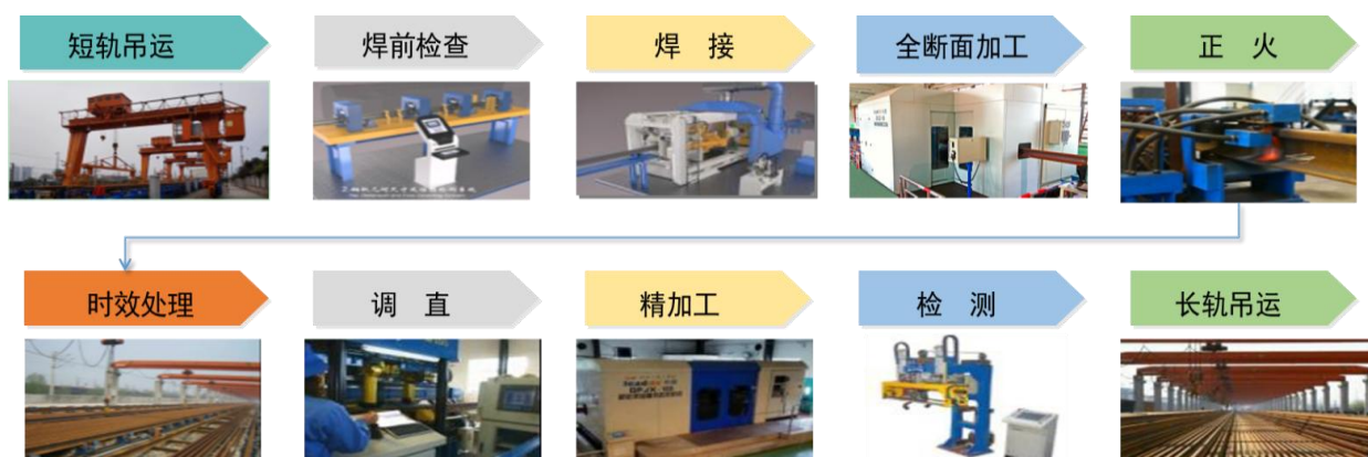
图：焊轨基地钢轨焊接核心设备
