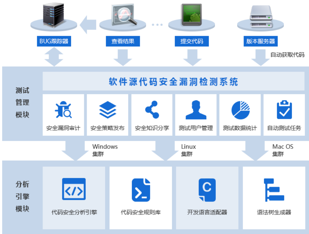
软件源代码安全漏洞检测系统示意
