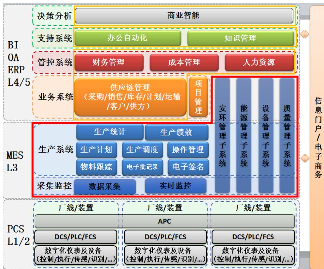
上图中实现智能制造的关键是第三层级的 MES 系统。目前，东北制药根据企业自身需求和发展需要，已经在第一、第二层级，第四、第五层级取得了相当的进步，但 MES 系统仍需进一步完善。MES 系统主要功能（红线方框内）包括：数据采集监控、生产管理系统、质量管理系统、设备管理系统、能源管理系统和安环管理系统。
