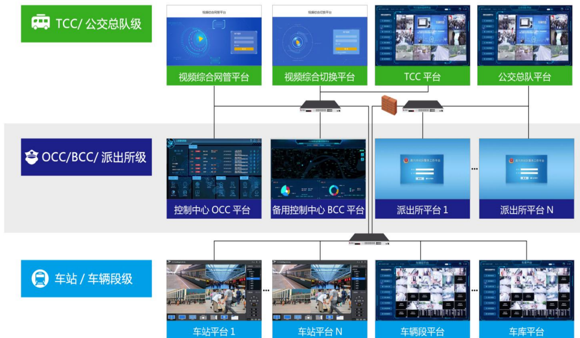
图：轨道交通视频监控系统架构
