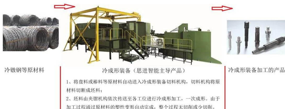
公司持续加大新产品研发力度。截至当前，公司可以生产八工位以内的冷成形装备。冷成形装备的“工位”数指加工产品过程中的变形次数，“工位”数一般与冷成形装备的定模数一致。公司冷成形装备在加工产品过程中，采用回转工作台或回转
