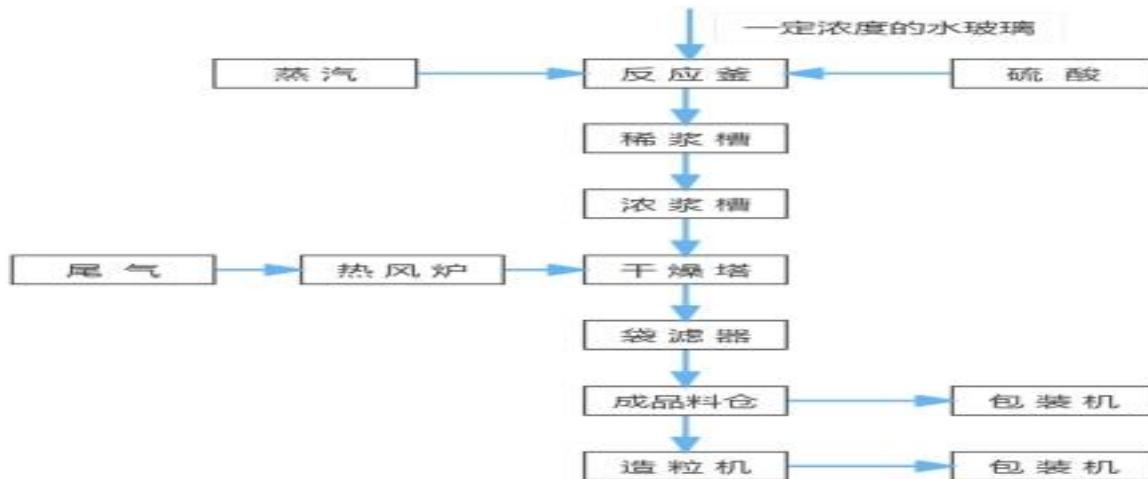
沉淀法白炭黑利用硅酸钠与硫酸反应制得，液体水玻璃加水调节到 20%-30% 的浓度送入下一道工序进行合成，在合成釜内先加入一定量的水和水玻璃，在 80-90℃ 温度下，同时加入硫酸和水玻璃并搅拌而生成白炭黑浆料，将浆料进入压滤机进行压滤，并用清水洗去其中的硫酸钠再进入打浆槽制得浓浆，用炭黑尾气燃烧产生的烟气与空气热交换，得到 500℃ 左右热风将经过雾化机雾化浓浆干燥为白炭黑粉末，用袋滤器收集后进行包装，根据需求，可将粉末状的白炭黑进行造粒，变成块状白炭黑进行包装销售。
