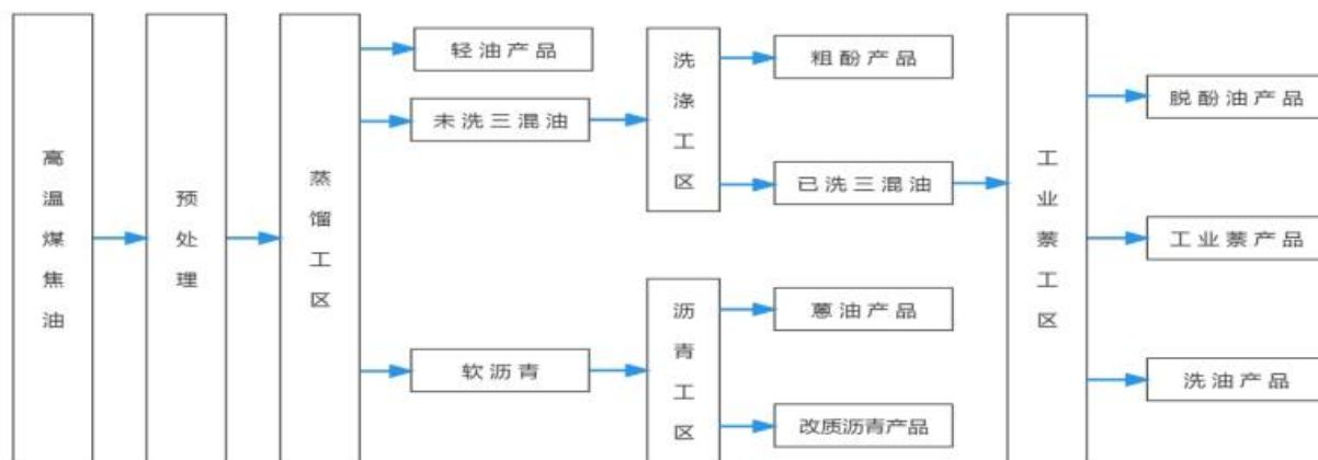
高温煤焦油是焦化工业的重要产品之一，其组分极为复杂。该工艺利用焦油中各组分沸点不同的性质，通过塔式常、减压蒸馏工艺分离出不同产品。
