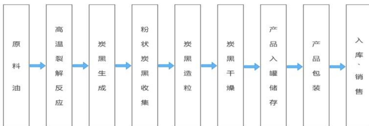
炭黑反应生成过程炭黑生产的核心是炭黑反应炉，燃料与空气先在反应炉的燃烧室完全燃烧产生高温烟气，并高速流经喉管。在喉管处，原料油由喷枪喷入反应炉，高温裂解反应生成炭黑及尾气。在此过程中，通过控制风、油配比、
