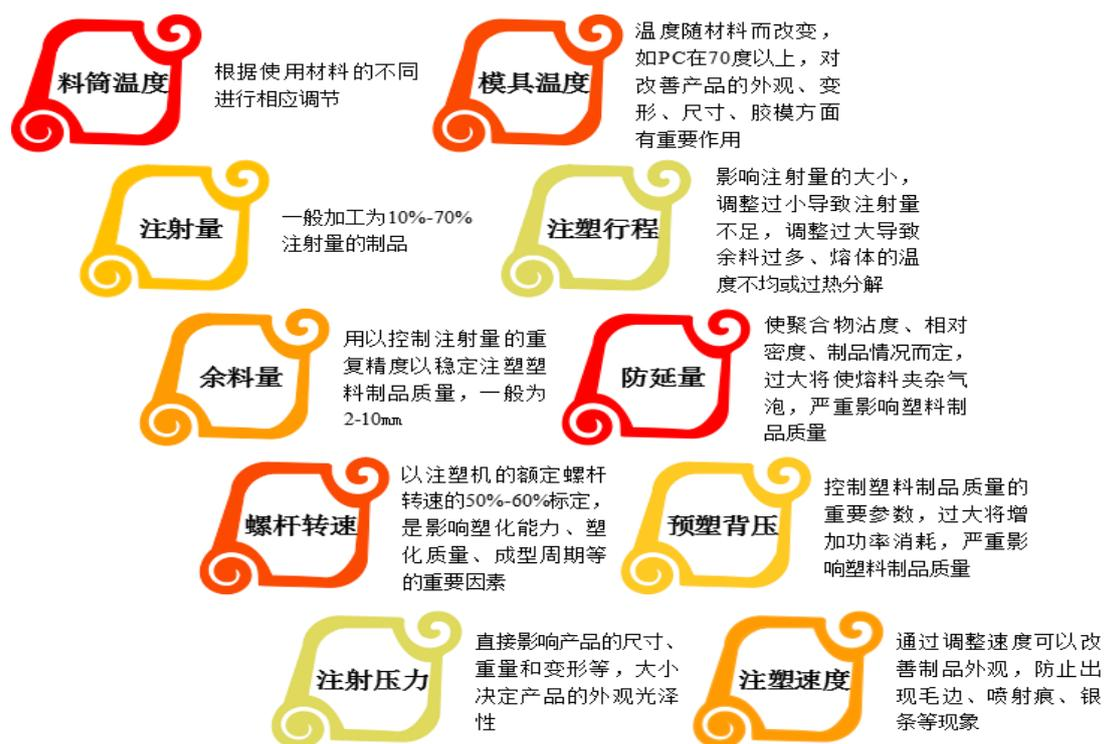
注塑工艺的优化有助于提高生产效率和产品质量，从而提升企业在行业的竞争力。随着新一代信息技术的发展，物联网、大数据等技术与注塑工艺的融合是大势所趋，物联网技术在注塑工艺的应用主要为智能化装备和智能化生产管理，通过传感器实时监控检测设备、模具情况，可以达到提高精确度、减少人工成本等作用，并实现快速积累生产数据以模具优化。大数据技术用于注塑主要对监测设备收集的大量数据进行分析整理，以此改进注塑工艺，实现设备最大化生产效率，提高产品质量并缩短制造周期等。在模具智能控制方面，可通过智能控制中
