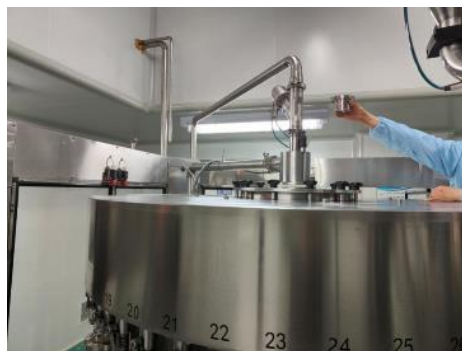
改造后：灌装机可升降并切换不同瓶型
