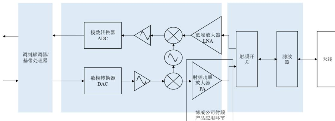
射频前端为 5G 基站的核心部分，博威公司主要产品射频功率放大器（PA）在其中的具体应用环节介绍如下：
