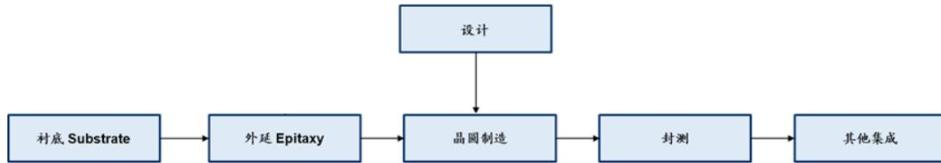
**衬底：**沿特定的结晶方向将晶体切割、研磨、抛光，得到具有特定晶面和适当电学、光学和机械特性，用于生长外延层或制造芯片的洁净单晶圆薄片。
