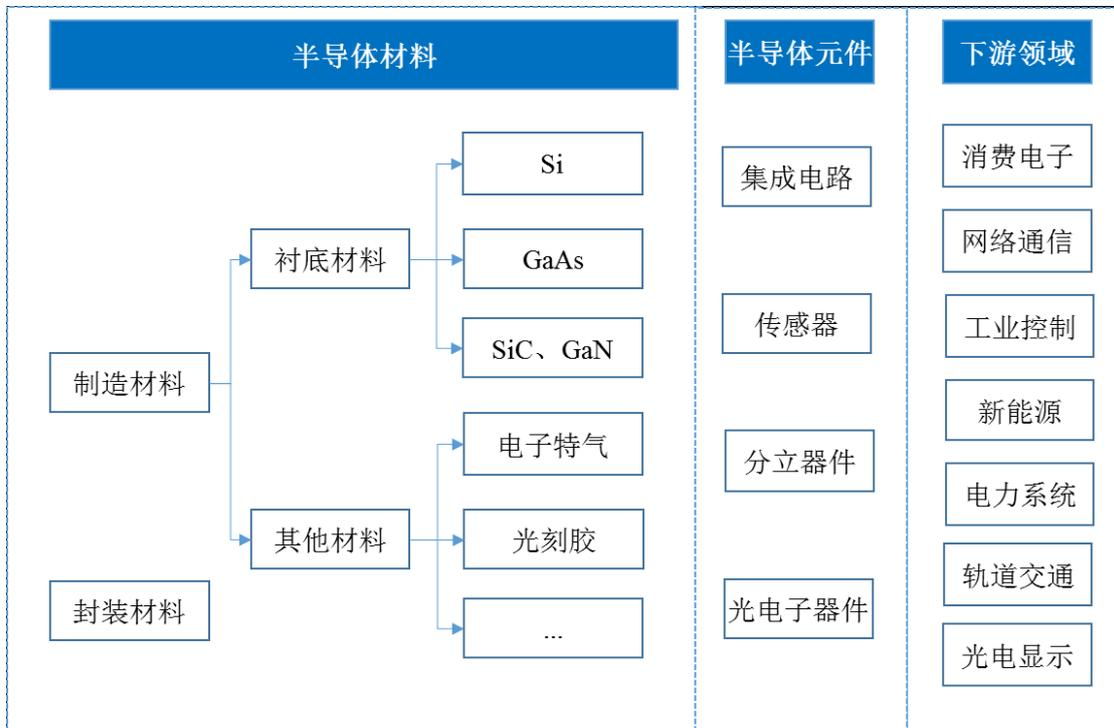
半导体相关重要产品为芯片、器件/模块等，其主要制作原材料为衬底或外延片。其中芯片是将晶圆上已经完成的具备特定电学性能的集成电路产品切割成一个个小单元；器件/模块是由单个或数个芯片及电容、电阻等元件经过设计、制造及封装/组装、测试等工序组成的具备一定功能的整体模块化集成电路产品。
