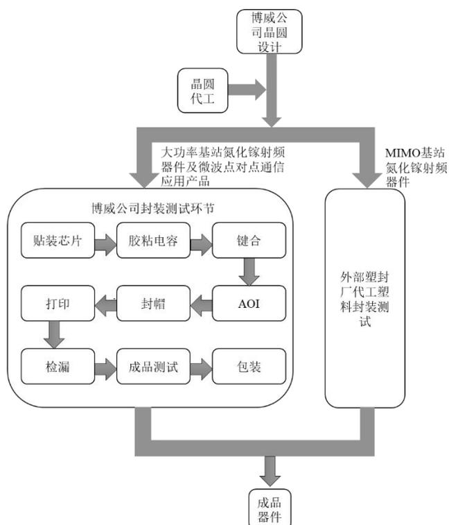
博威公司主要产品中，相关晶圆设计由博威公司完成，晶圆制造委外加工。陶瓷封装的大功率基站氮化镓射频芯片及器件及微波点对点通信应用产品相关封装测试加工节点由博威公司自行完成；塑料封装的 MIMO 基站氮化镓射频芯片及器件相关封装测试加工节点由博威公司委托外部加工。
