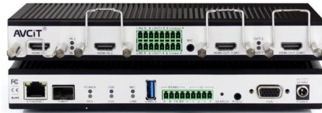
公司光纤分布式系统除具备系统稳定、信号无压缩零帧延迟、使用独立物理通道承载音视频及 USB 数据、并发处理能力强、信息安全度高等优势外，还具备类似 IP 分布式系统的友好的人机界面和使用体验，如可视化 KVM 坐席、多分屏坐席、可视化 4K 拼接等，以及完全不同于拼接矩阵的自动寻址全能端口组网功能，非常适合本地和局域网场景中的应用，受到如轨道交通、电力调度、电竞、空管等对“延时、画质、安全”要求较高的专业领域的青睐。
