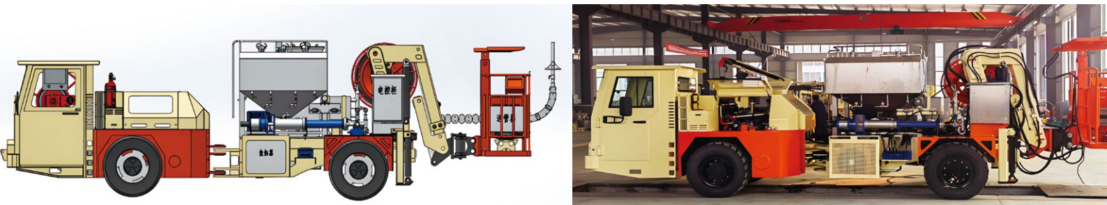
地下现场混装乳化炸药车
