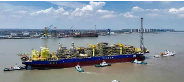
EH36 级别及以上高强钢应用于世界最大的天然气处理 浮式储卸油平台
