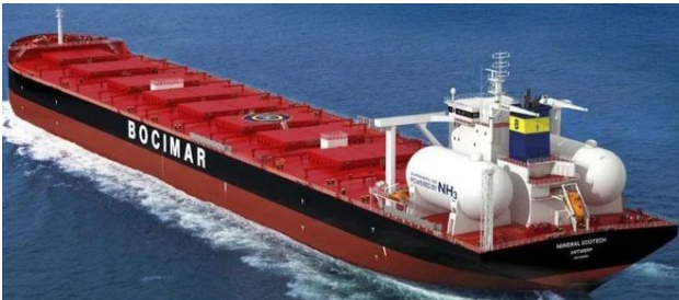
低温钢在全球首制液氨动力散货船燃料罐实现首发应用
