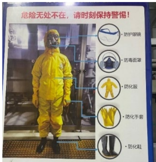
化学品操作安全防护警示牌
