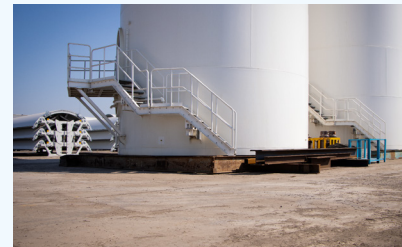
废旧钢板制作的塔筒安放鞍座
