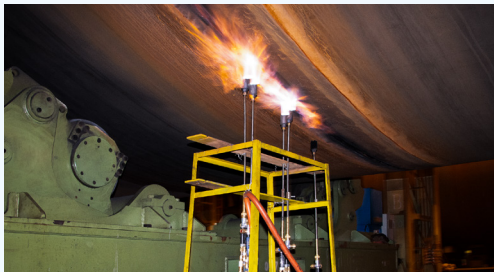
改进后的单桩焊接预热工艺
