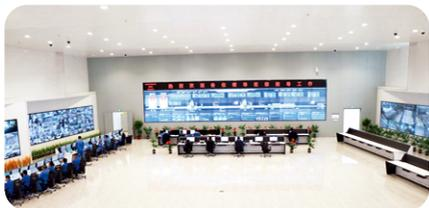
中厚板 4300 产线智能集控覆盖产线加热炉区、轧区、层冷区、矫直区、精整剪切区、冷矫直机等多个区域的操控与调度，有效解决各操作台分布离散、作业效率低、人工干预多、生产不稳定等问题。实现从加热炉区自动装钢、自动出钢到轧机区域全自动轧钢，能够实时跟踪轧机质量检测装置的运行状况和质量检测仪器的监测数据，实现中厚板生产高效协同，提高产品质量，降低生产成本。
