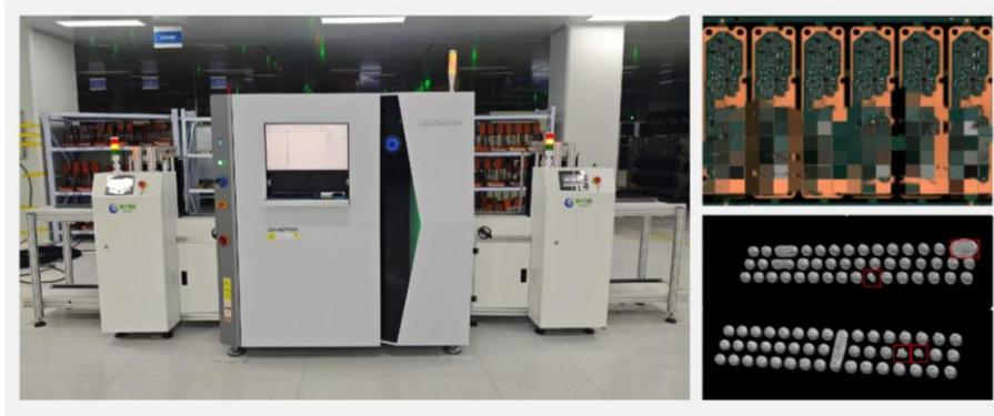
在汽车传感器生产过程中，需对内部感应装置的缺陷缺失进行检测，但由于外部塑料包裹，仅凭肉眼无法发现。通过 X 射线高清透视成像以及 AI 算法，能够直观呈现内部针体是否歪斜、长短是否异常，批量线体自动检测、判别缺陷，自动剔除问题产品，大幅提高检测效率，解决人工检测难度大、效率低的问题。通过扫码功能定制，物料条码与 X 光图绑定，实现问题产品的跟踪追溯，为生产提供了有力的品质保障。
