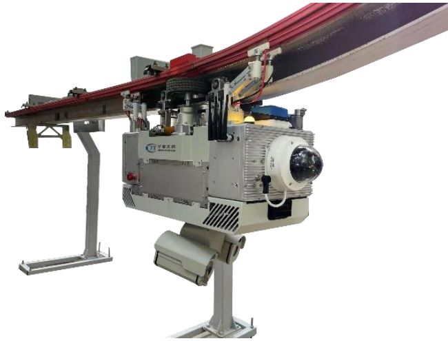
图 17、极寒轨道式智能巡检机器人
