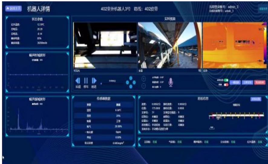
图 15、智能机器人巡检系统平台
