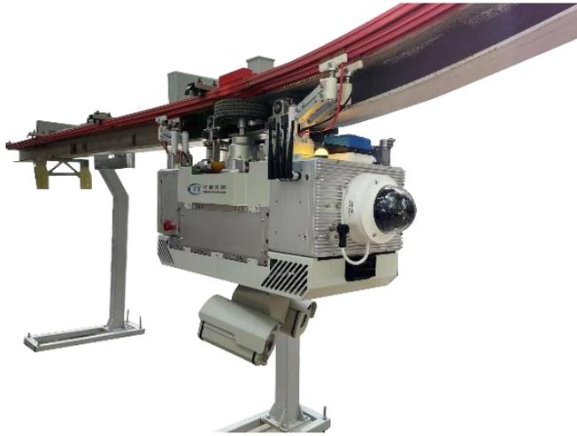
图 17、极寒轨道式智能巡检机器人
