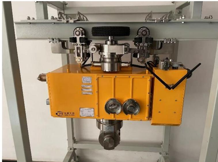
图 16、防爆式轨道智能巡检机器人
