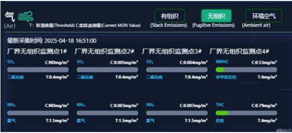
格林美（荆门）园区无组织废气实时监测
