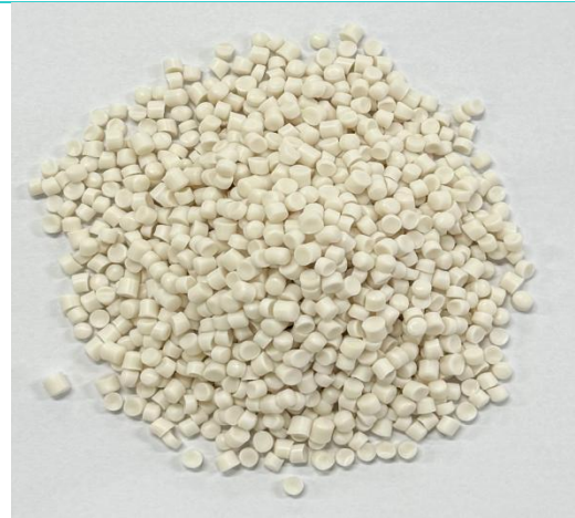
图：聚氯乙烯电缆料
