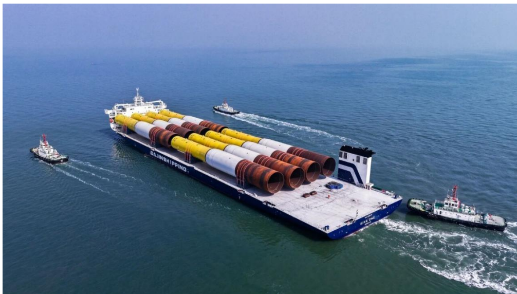
2026 年 5 月，KING ONE 轮第二个跨洋航次启程，运输直径 11 米 TP-less 无过渡段风电单桩至欧洲某港口
