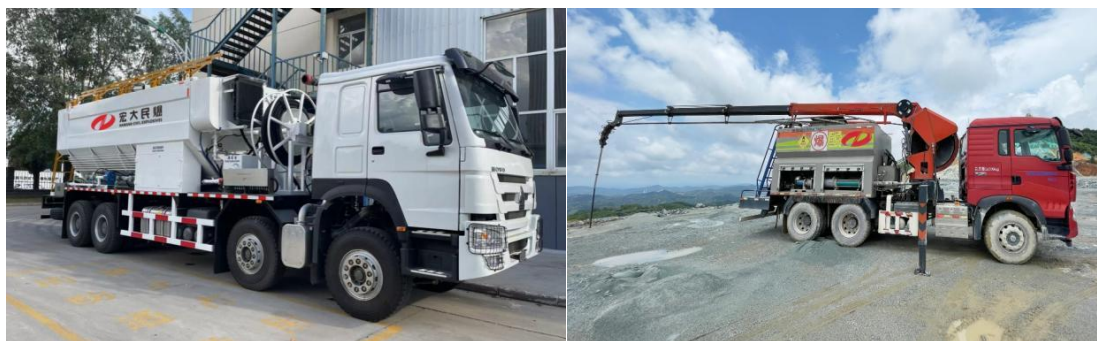
图十一 现场混装炸药车
