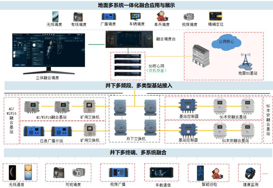
图 1：融合通信架构图
