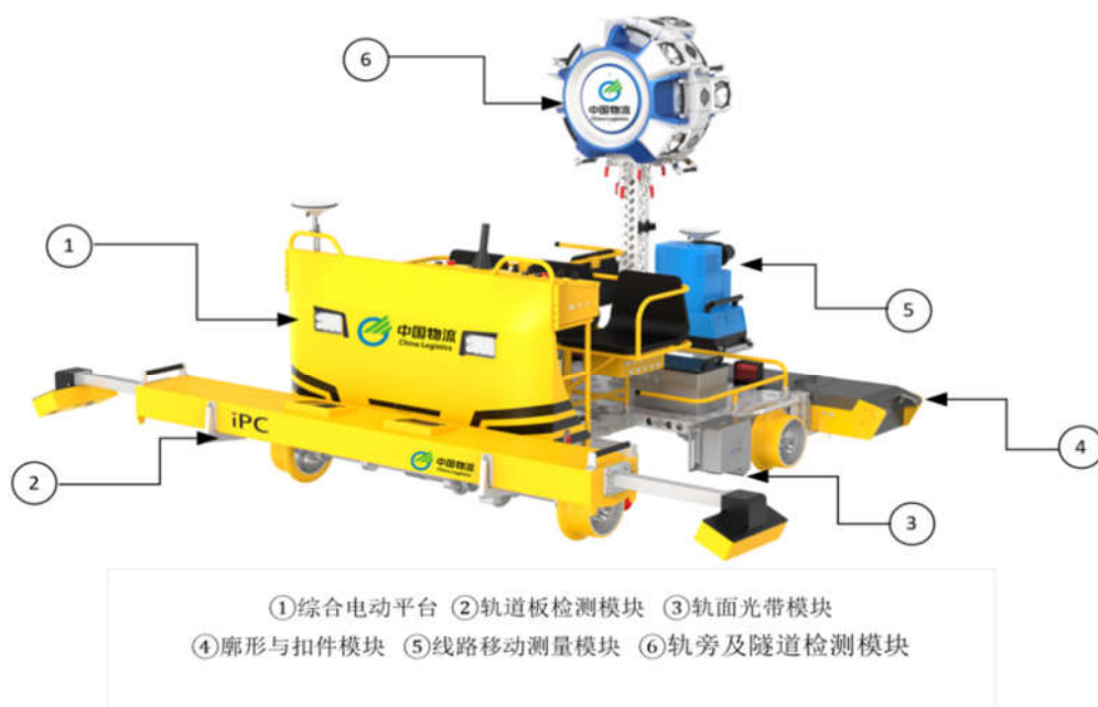
图 7：轨道线路综合检测平台
