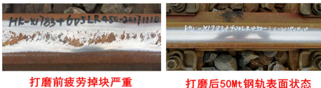
图 4：钢轨打磨前后状态对比
