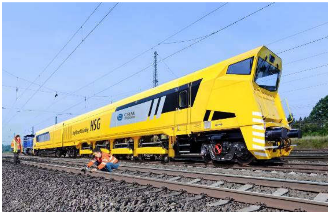
图 3：钢轨快速打磨车
