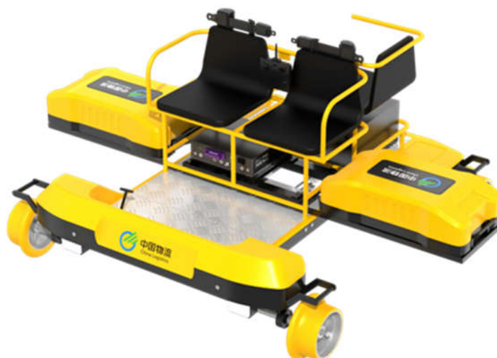
图 8：钢轨状态综合检测平台
