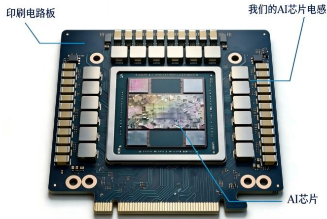
AI 芯片电感集成至客户终端产品的结构示意图
