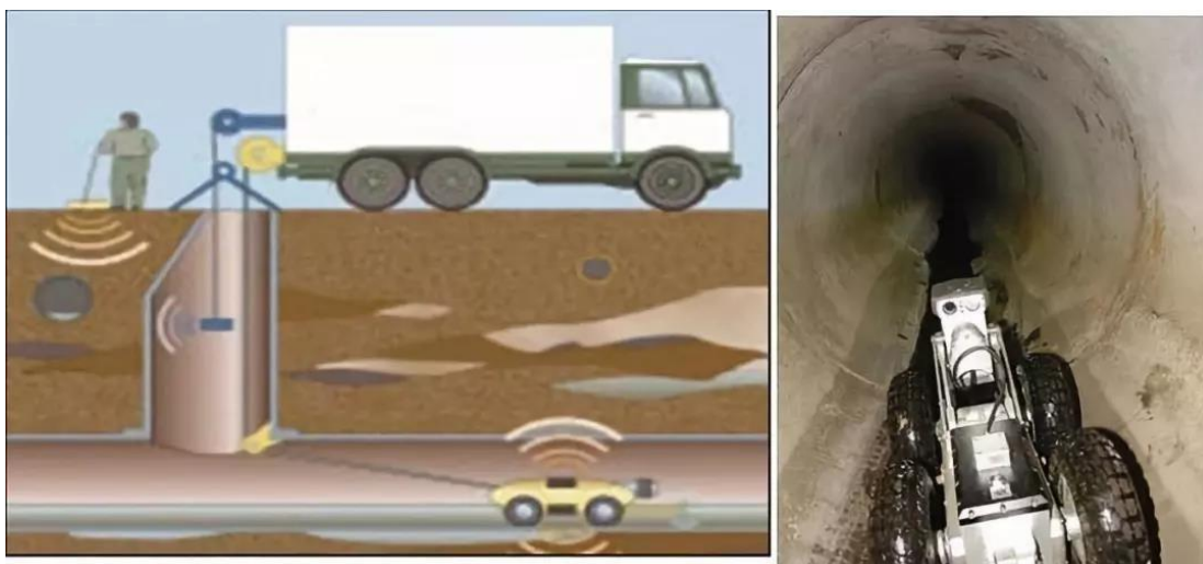
管道内部视频检测
