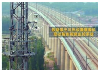
激光与热成像摄像机联动智能视频分析监控系统
