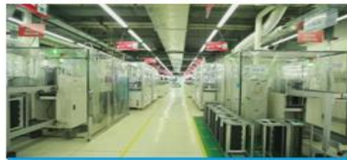
全自动单板测试线 机器人搬运，配合测试工装仪器
