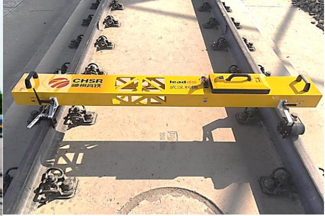
图：轨道扣件检测系统
