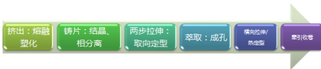
图一 湿法隔膜生产主要工艺流程
