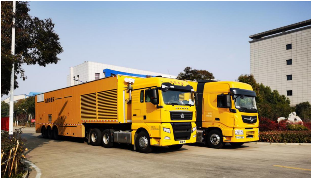
半挂应急电源车（2000kW）
