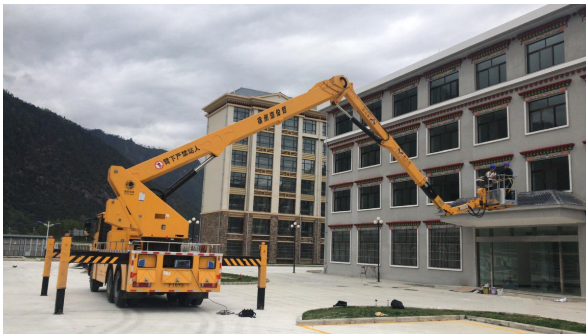
35 米混合臂高空作业车
