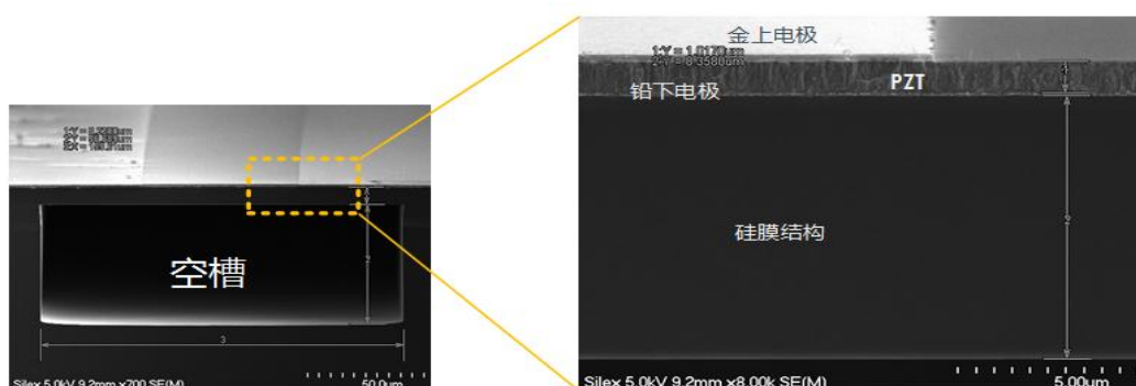
压电材料（PTZ）工艺技术图示
