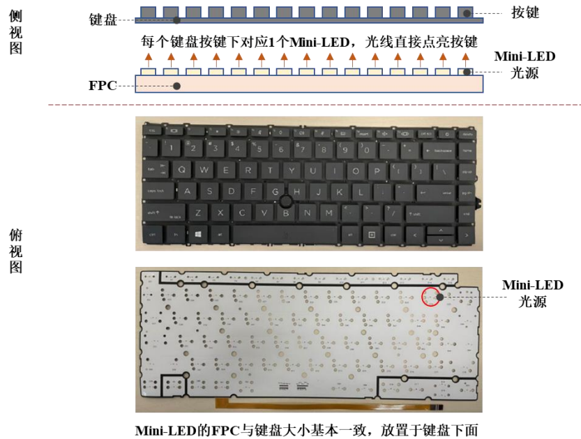
图：笔记本电脑键盘 Mini-LED 背光模组原理示意图
